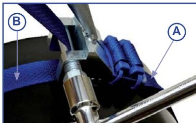
4 - Con una llave de 19, tense la correa en aproximadamente 60 Newton/metro. Luego corte (\*) la correa a ambos lados del CLIP a 30 mm (mini).
